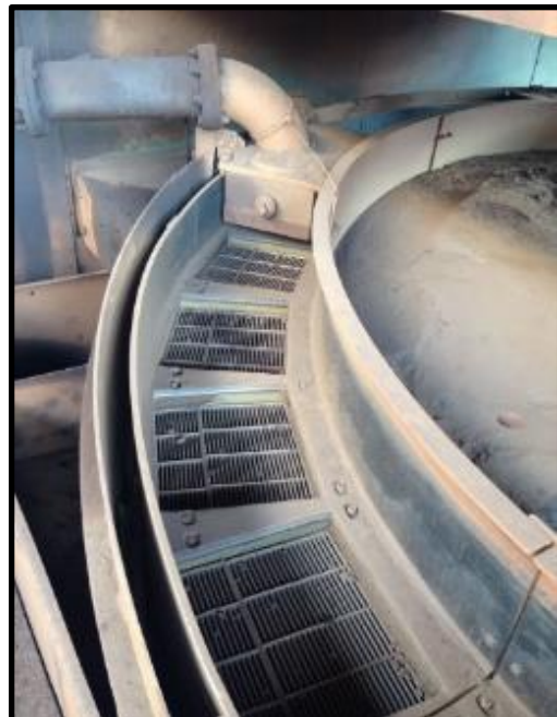
FIGURA 3 – Ocorrendo falha nas telas das peneiras, ocorre o entupimento das matrizes (GAP: 2,5 mm) dos SMs.
